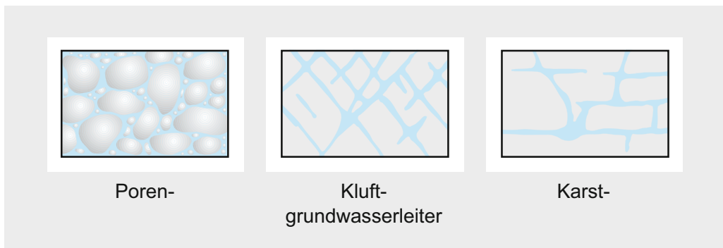
Abb. 6: Poren-, Kluft- und Karstgrundwasserleiter.
